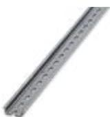
Guida di supporto forata, Profilo standard, larghezza: 35 mm, altezza: 7,5 mm, a norma EN 60715, materiale: Acciaio, zincato, passivato bianco, lunghezza: 2000 mm, colore: color argento
