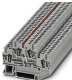
Componente morsetto componibile , tensione nominale: 250 V, corrente nominale: 22 A, collegamento: Connessione a molla, sezione: 0,08 mm<sup>2</sup> - 4 mm<sup>2</sup>, AWG: 28 - 12, lunghezza: 67,5 mm, larghezza: 5,2 mm, colore: grigio, montaggio: NS 35/7,5, NS 35/15
