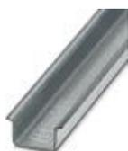
Guida di supporto, non perforata, Profilo standard, larghezza: 35 mm, altezza: 15 mm, simile a norma EN 60715, materiale: Acciaio, zincata, lunghezza: 2000 mm, colore: color argento
