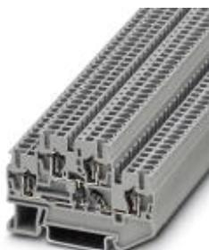
Componente morsetto componibile , con diodo integrato, tensione nominale: 250 V, corrente nominale: 22 A, collegamento: Connessione a molla, sezione: 0,08 mm<sup>2</sup> - 4 mm<sup>2</sup>, AWG: 28 - 12, lunghezza: 67,5 mm, larghezza: 5,2 mm, colore: grigio, montaggio: NS 35/7,5, NS 35/15
