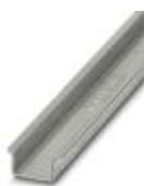
Guida di supporto, non perforata, Profilo standard 2,3 mm, larghezza: 35 mm, altezza: 15 mm, a norma EN 60715, materiale: Acciaio, zincato, passivato a strato spesso, lunghezza: 2000 mm, colore: color argento
