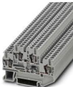
Componente morsetto componibile , con diodo integrato, tensione nominale: 500 V, corrente nominale: 22 A, collegamento: Connessione a molla, sezione: 0,08 mm<sup>2</sup> - 4 mm<sup>2</sup>, AWG: 28 - 12, lunghezza: 67,5 mm, larghezza: 5,2 mm, colore: grigio, montaggio: NS 35/7,5, NS 35/15
