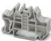
Supporto finale a montaggio rapido, per guida NS 35/7,5 oppure per guida NS 35/15, con possibilità di siglatura, spessore: 9,5 mm, colore: grigio
