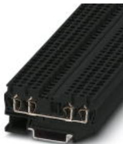
Componente morsetto componibile , per il montaggio di componenti selezionabili a piacere, tensione nominale: 800 V, corrente nominale: 24 A, collegamento: Connessione a molla, numero di connessioni: 4, sezione: 0,08 mm<sup>2</sup> - 4 mm<sup>2</sup>, AWG: 28 - 12, larghezza: 5,2 mm, colore: nero, tipo di montaggio: NS 35/7,5, NS 35/15
