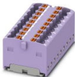
Blocco distributore, ponticellato internamente, I blocchi sono ponticellabili tra di loro sopra il vano conduttori. Per ponticelli a innesto adatti, vedere accessori, tensione nominale: 450 V, corrente nominale: 17,5 A, collegamento: Connessione Push-in, numero di connessioni: 18, sezione: 0,14 mm<sup>2</sup> - 2,5 mm<sup>2</sup>, AWG: 26 - 14, larghezza: 37,4 mm, altezza: 18,7 mm, colore: viola, tipo di montaggio: incollare
