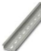
Guida di supporto forata, Profilo standard, larghezza: 35 mm, altezza: 7,5 mm, a norma EN 60715, materiale: Acciaio, zincato, passivato a strato spesso, lunghezza: 2000 mm, colore: argento
