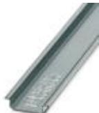
Guida di supporto, non perforata, Profilo standard, larghezza: 35 mm, altezza: 7,5 mm, a norma EN 60715,
