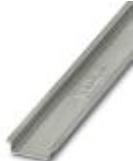
Guida di supporto, non perforata, Profilo standard, larghezza: 35 mm, altezza: 7,5 mm, a norma EN 60715,
