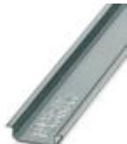
Guida di supporto, non perforata, Profilo standard, larghezza: 35 mm, altezza: 7,5 mm, a norma EN 60715, materiale: alluminio, non rivestito, lunghezza: 2000 mm, colore: color argento
