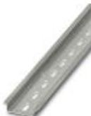
Guida di supporto forata, Profilo standard, larghezza: 35 mm, altezza: 7,5 mm, a norma EN 60715, materiale: Acciaio, zincato, passivato a strato spesso, lunghezza: 2000 mm, colore: argento
