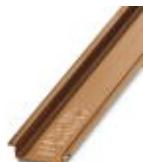
Guida di supporto, non perforata, Profilo standard, larghezza: 35 mm, altezza: 7,5 mm, a norma EN 60715, materiale: rame, non rivestito, lunghezza: 2000 mm, colore: rame
