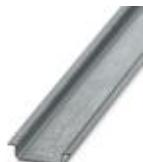
Guida di supporto, non perforata, Profilo standard, larghezza: 35 mm, altezza: 7,5 mm, a norma EN 60715, materiale: Acciaio, zincata, lunghezza: 2000 mm, colore: color argento
