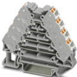
Ripartitori, tensione nominale: 250 V, corrente nominale: 10 A, sezione: 0,14 mm<sup>2</sup> - 2,5 mm<sup>2</sup>, AWG: 12 - 26, collegamento: Connessione Push-in, numero poli: 2, numero connessioni: 16, larghezza: 8,3 mm, lunghezza: 64 mm, colore: grigio, montaggio: NS 35/7,5, NS 35/15
