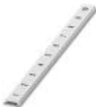
Nastro Zack piatto, Striscia, bianco, siglato, siglatura longitudinale: numeri progressivi 1 ...10, 11 ...20 ecc. fino a 101 ...110, tipo di montaggio: inserimento a scatto in scanalatura piatta portacartellini, per morsetti con spessore: 8 mm, dimensioni campo di siglatura: 5,15 x 8,15 mm, Numero dei cartellini singoli: 10
