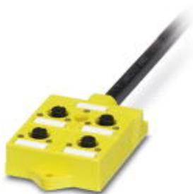
Il box sensore PSR-SACB per finecorsa di sicur. collega in perfetto stato di sicurezza tecnica fino a 4 finecorsa collegati dotati ciascuno di 1 contatto in apert. e 1 in chius. con una combinaz. di moduli di sicur., ad es. PSR-SDC4, lungh.: 10 m
