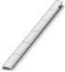
Nastro Zack, Striscia, bianco, in bianco, siglabile con: CMS-P1-PLOTTER, PLOTMARK, tipo di montaggio: inserimento a scatto in scanalatura alta portacartellini, per morsetti con spessore: 18 mm, dimensioni campo di siglatura: 18 x 5 mm, Numero dei cartellini singoli: 5
