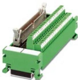
Modulo VARIOFACE-COMPACT-LINE, per 32 canali con indicazione luminosa, per montaggio su guida di supporto NS 35/7.5, connessione a vite
