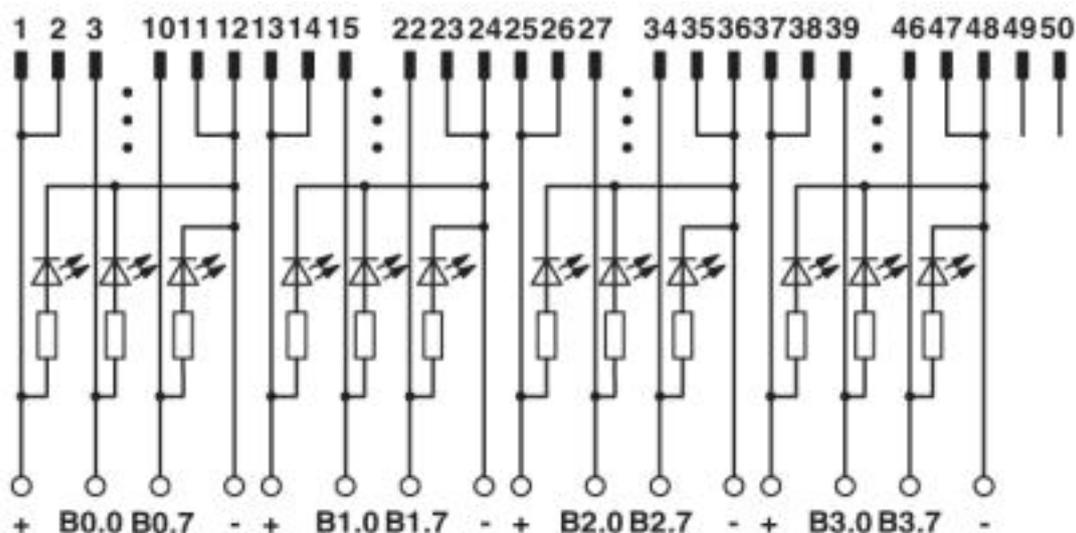
Schema di collegamento UM 45-FLK50/LA/PLC
