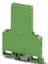
Relè a stato solido di ingresso, con LED e protezione nei circuiti di ingresso e uscita, ingresso: 220 V DC, uscita: 4 - 48 V DC/max. 100 mA
