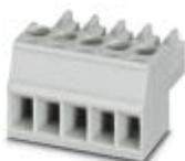
Connettore per circuiti stampati, corrente nominale: 8 A, tensione di dimensionamento (III/2): 160 V, sezione nominale: 1,5 mm<sup>2</sup>, numero poli: 4, passo: 3,5 mm, collegamento: Connessione a vite con gabbia, colore: grigio chiaro, superficie contatti: Stagno
