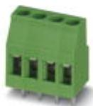
Morsetto per circuiti stampati, corrente nominale: 24 A, tensione di dimensionamento (III/2): 400 V, sezione nominale: 2,5 mm<sup>2</sup>, passo: 5 mm, numero poli: 4, collegamento: Connessione a vite con gabbia, montaggio: Saldatura ad onde, direzione di collegamento conduttore/scheda: 0 °, colore: verde, Layout Pin: Pinning lineare, Lunghezza pin [P]: 5 mm. L'articolo può essere allineato con diversi numeri di poli!
