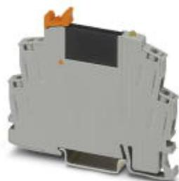
Modulo portarelè a stato solido montato con connessione a vite, composto da: base relè con espulsore e relè a stato solido in miniatura a innesto. Tensione di ingresso: 24 V DC. Uscita: 24-253 V AC/0,75 A
