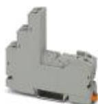
Base per relè RIF-1..., per relè di potenza in miniatura con 1 o 2 contatti di scambio o relè a stato solido equivalenti dal punto di vista costruttivo, connessione a vite, possibilità d'innesto per modulo d'ingresso/antidisturbo, per il montaggio su NS 35/7,5
