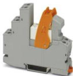
Modulo portarelè montato con connessione a vite, composto da: base relè, relè a contatto di potenza, modulo di segnalazione di stato e di soppressione dei disturbi a innesto e leva di fissaggio. Esecuzione contatti: 1 contatto di scambio. Tensione di ingresso: 230 V AC
