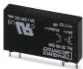
Relè a stato solido in miniatura a innesto, relè a stato solido di potenza, 1 contatto aperto a riposo, ingresso: 24 V DC, uscita: 3 ... 33 V DC/ 3 A
