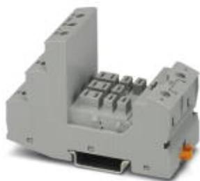
Base relè RIF-4..., per relè con elevata potenza con 2 o 3 contatti di scambio o 3 contatti in chiusura, connessione a vite, possibilità d'innesto per modulo d'ingresso/antidisturbo, per il montaggio su NS 35/7,5
