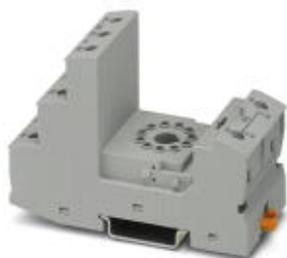
Base relè RIF-3..., per relè Octal con 3 contatti di scambio, connessione a vite, possibilità d'innesto per moduli d'ingresso/antidisturbo, per il montaggio su NS 35/7,5
