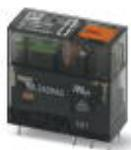
Relè in miniatura ad innesto, con contatto di potenza, 2 contatti di scambio, tasto di prova, segnalazione meccanica di stato, LED di stato, tensione bobina 120 V AC
