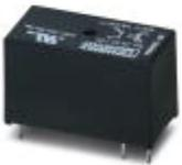
Relè a stato solido in miniatura a innesto, relè a stato solido di potenza, 1 contatto aperto a riposo, ingresso: 60 V DC, uscita: 3-33 V DC/ 5 A
