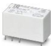
Relè di potenza in miniatura a innesto, con contatto in oro multistrato, 2 contatti di scambio, tensione di ingresso 230 V AC
