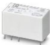
Relè di potenza in miniatura a innesto, con contatto in oro multistrato per elevate correnti permanenti, 1 contatto di scambio, tensione di ingresso 24 V DC
