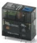
Relè in miniatura ad innesto, con contatto multistrato e doratura a spessore, 2 contatti di scambio, tasto di prova, segnalazione meccanica di stato, LED di stato, diodo di smorzamento, polarità A1+, A2-, tensione d'ingresso 24 V DC
