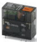
Relè in miniatura ad innesto, con contatto di potenza, 2 contatti di scambio, tasto di prova, segnalazione meccanica di stato, LED di stato, tensione d'ingresso 24 V AC
