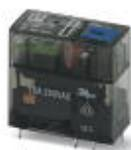
Relè in miniatura ad innesto, con contatto di potenza, 1 contatto di scambio, tasto di prova, segnalazione meccanica di stato, LED di stato, diodo di smorzamento, polarità A1+, A2-, tensione d'ingresso 24 V DC
