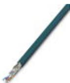
Cavo CAT5-SF/UTP (J-LI02YS(ST)C H 2 x 2 x 26 AWG) leggero cavo flessibile 2 x 2 x 0,14 mm<sup>2</sup>, conduttori sottili, schermato, guaina esterna: diametro 5,75 mm ± 0,15 mm
