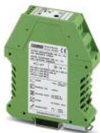
Convertitore di corrente MCR, configurabile, per la misurazione di correnti continue, alternate e distorte, corrente in ingresso da 0...10 a 0...50 A, non configurato, uscita segnali analogici
