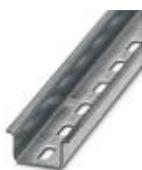
Guida di supporto forata, Profilo standard, larghezza: 35 mm, altezza: 15 mm, simile a norma EN 60715, materiale: Acciaio, zincata, lunghezza: 2000 mm, colore: color argento
