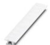
Nastro Zack, Striscia, bianco, in bianco, siglabile con: PLOTMARK, CMS-P1-PLOTTER, tipo di montaggio: inserimento a scatto in scanalatura alta portacartellini, per morsetti con spessore: 6,2 mm, dimensioni campo di siglatura: 6,15 x 10,5 mm, Numero dei cartellini singoli: 10
