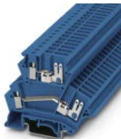
Morsetto passante, collegamento: Connessione a vite, Faston, sezione: 0,2 mm<sup>2</sup> - 4 mm<sup>2</sup>, AWG: 24 - 12, larghezza: 6,2 mm, colore: blu, montaggio: NS 35/7,5, NS 35/15, NS 32
