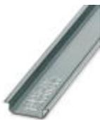
Guida di supporto, non perforata, Profilo standard, larghezza: 35 mm, altezza: 7,5 mm, a norma EN 60715, materiale: Acciaio, zincato, passivato bianco, lunghezza: 2000 mm, colore: color argento
