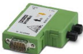
Convertitore in fibra ottica INTERBUS per la conversione dell'interfaccia remota OUT in conduttore in fibra ottica, regolazione della capacità di trasmissione ottica, velocità di trasmissione di 2 MBaud, uscita FO a destra
