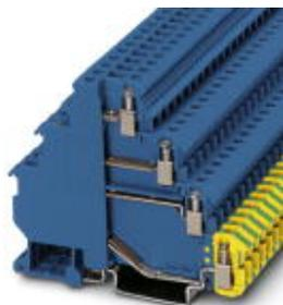
Morsetti per sensori e attuatori, collegamento: Connessione a vite, sezione: 0,2 mm<sup>2</sup> - 4 mm<sup>2</sup>, AWG: 24 - 12, larghezza: 6,2 mm, colore: blu, tipo di montaggio: NS 35/7,5, NS 35/15
