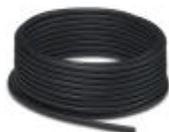
In metri, Cavo bus remoto di installazione, INTERBUS, schermata, PVC/PVC, nero RAL 9005, 9-conduttori (3 x 2 x 0,22 mm<sup>2</sup> + 3 x 1 mm<sup>2</sup>), colore conduttore singolo: verde-giallo, bianco-marrone, grigio-rosa, rosso, blu, verde/giallo, interrabile
