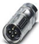
Connettore per cavi, diritto, Bloccaggio SPEEDCON, M17, numero poli: 5+3+PE, tipo contatti: Maschio, Attacco a crimpare, schermata: sì, diametro cavi: 8 mm ... 10 mm
