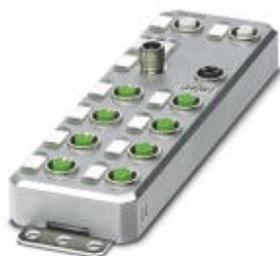
Axioline E, Dispositivo di ingresso/uscita digitale, PROFINET, Sistema a connessione rapida M12, Ingressi digitali: 8, 24 V DC, tecnica di connessione: 4 conduttori, Uscite digitali: 8, 24 V DC, 500 mA, tecnica di connessione: 3 conduttori, Custodia metallica, grado di protezione: IP65/IP67
