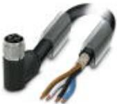
Cavo Power, 4-poli, PUR senza alogenati, nero RAL 9005, schermata (Advanced Shielding Technology), estremità conduttore libera, su Femmina angolato M12, codifica: T, lunghezza cavo: 1,5 m, per corrente continua fino a 12 A / 63 V
