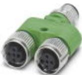
Distributore a Y, 4-poli, Maschio diritto M12 SPEEDCON, codifica: A, su Femmina diritto M12 SPEEDCON, codifica: A, PIN 2+4 ponticellati e Femmina diritto M12 SPEEDCON, codifica: A, PIN 2+4 ponticellati, Filettatura connettore femmina M12 non ruotabile
