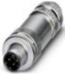
Connettori bus, Ethernet/PROFINET CAT5 (100 MBit/s), 4-poli, schermata, Maschio diritto M12, codifica D, Connessione a vite, materiale zigrinato: Pressogetto di zinco, nichelato, connessione a vite per cavo Pg9, diametro esterno cavo 6 mm ... 8 mm
