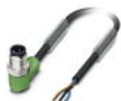
Cavo sensore-attuatore, 3-poli, Tipo di cavo variabile, Maschio angolato M12, codifica: A, su estremità conduttore libera, lunghezza cavo: Ingresso libero (0,2 ... 40,0 m)
