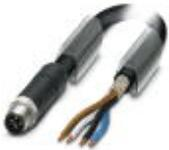
Cavo Power, 4-poli, PUR senza alogenati, nero RAL 9005, schermata (Advanced Shielding Technology), Maschio diritto M12, codifica: T, su estremità conduttore libera, lunghezza cavo: 1,5 m, per corrente continua fino a 12 A / 63 V
