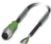
Cavo sensore-attuatore, 5-poli, Tipo di cavo variabile, Maschio diritto M12, codifica: A, su estremità conduttore libera, lunghezza cavo: Ingresso libero (0,2 ... 40,0 m)
