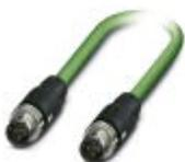
Cavo di rete, PROFINET CAT5 (100 MBit/s), EtherCAT® CAT5 (100 MBit/s), 4-poli, Tipo di cavo variabile, schermata, Maschio diritto M12 SPEEDCON / IP67, codifica: D, su Maschio diritto M12 SPEEDCON / IP67, codifica: D, lunghezza cavo: Ingresso libero (0,2 ... 40,0 m)
