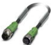
Cavo sensore-attuatore, 5-poli, Tipo di cavo variabile, Maschio diritto M12 SPEEDCON, codifica: A, su Femmina diritto M12 SPEEDCON, codifica: A, lunghezza cavo: Ingresso libero (0,2 ... 40,0 m)
