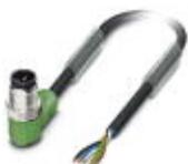
Cavo sensore-attuatore, 5-poli, Tipo di cavo variabile, Maschio angolato M12, codifica: A, su estremità conduttore libera, lunghezza cavo: Ingresso libero (0,2 ... 40,0 m)
