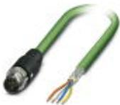
Cavo di rete, PROFINET CAT5 (100 MBit/s), EtherCAT® CAT5 (100 MBit/s), 4-poli, Tipo di cavo variabile, schermata, Maschio diritto M12 SPEEDCON / IP67, codifica: D, su estremità conduttore libera, lunghezza cavo: Ingresso libero (0,2 ... 40,0 m)
