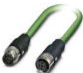
Cavo di rete, PROFINET CAT5 (100 MBit/s), EtherCAT® CAT5 (100 MBit/s), 4-poli, Tipo di cavo variabile, schermata, Maschio diritto M12 SPEEDCON / IP67, codifica: D, su Femmina diritto M12 SPEEDCON / IP67, codifica: D, lunghezza cavo: Ingresso libero (0,2 ... 40,0 m)
