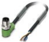
Cavo sensore-attuatore, 4-poli, Tipo di cavo variabile, Maschio angolato M12 SPEEDCON, codifica: A, su estremità conduttore libera, lunghezza cavo: Ingresso libero (0,2 ... 40,0 m)
