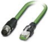
Cavo di rete, PROFINET CAT5 (100 MBit/s), EtherCAT® CAT5 (100 MBit/s), 4-poli, Tipo di cavo variabile, schermata, Maschio diritto M12 SPEEDCON / IP67, codifica: D, su Maschio diritto RJ45 / IP20, lunghezza cavo: Ingresso libero (0,2 ... 40,0 m)
