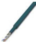
Cavo CAT5-SF/UTP (J-02YS(ST)C HP 2 x 2 x 24 AWG) robusto cavo, 2 x 2 x 0,22 mm<sup>2</sup>, conduttori rigidi, schermati, guaina esterna: diametro 7,8 mm, guaina interna: diametro 5,75 mm ± 0,15 mm
