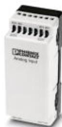
Modulo d'espansione I/O con un'unità di base Nanoline. Questo modello dispone di 2 canali di ingresso analogici (0...10 V DC, -10...+10 V DC, 0/4...20 mA) e 2 canali di uscita analogici (0...10 V DC, 0/4...20 mA). Si possono collegare un massimo di tre moduli d'espansione I/O all'unità di base.
