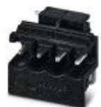
Presa base per circuiti stampati, numero poli: 4, passo: 5 mm, colore: nero, superficie contatti: Stagno, layout pin: Pinning lineare, lunghezza pin [P]: 2,5 mm
