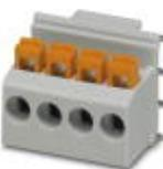
Morsetto per circuiti stampati, corrente nominale: 22 A, tensione di dimensionamento (III/2): 250 V, sezione nominale: 2,5 mm<sup>2</sup>, passo: 5 mm, numero poli: 4, collegamento: Connessione a molla Push-in, montaggio: Saldatura ad onde, direzione di collegamento conduttore/scheda: 0 °, colore: grigio chiaro, Layout Pin: Pinning lineare, Lunghezza pin [P]: 3,5 mm. Articolo con uscita pin laterale
