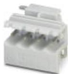
Presa base per circuiti stampati, numero poli: 4, passo: 5 mm, colore: grigio chiaro, superficie contatti: Stagno, layout pin: Pinning lineare, lunghezza pin [P]: 3,5 mm
