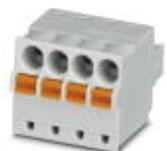
Connettore per circuiti stampati, corrente nominale: 8 A, tensione di dimensionamento (III/2): 160 V, sezione nominale: 1,5 mm<sup>2</sup>, numero poli: 5, passo: 3,5 mm, collegamento: Connessione a molla Push-in, colore: grigio chiaro, superficie contatti: Stagno
