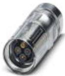
Connettore per cavi, diritto, Bloccaggio SPEEDCON, M17, numero poli: 5+3+PE, tipo contatti: femmina, Attacco a crimpare, schermata: sì, diametro cavi: 8 mm ... 10 mm
