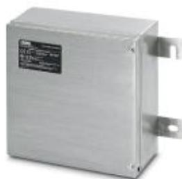
Scatola di comando sul campo in acciaio legato con dieci connessioni per l'impiego in una zona Ex. Contiene blocco accoppiatore di dispositivi a 6 vie (FB-6SP) per FOUNDATION Fieldbus o PROFIBUS PA, cablaggio di distribuzione (+, -, S) collegato a un dispositivo di protezione PLUGTRAB (PT 4+F-BE)
