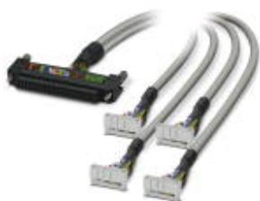
Cavo intestato; controllore: OMRON CJ1 (OD 231, OD 261), CQM1 (OD 213, OD 112), CS1, C200H (OD 218, OD 219); collegamento 1: Connettore Fujitsu (1x 40-poli); collegamento 2: IDC/FLK conduttore femmina (4x 14-poli); lunghezza cavo: 1 m
