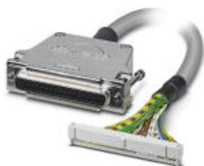
Cavo intestato; controllore: Mitsubishi Electric MELSEC Q (X81); collegamento 1: Connettore femmina D-SUB (1x 37-poli); collegamento 2: IDC/FLK conduttore femmina (1x 50-poli); lunghezza cavo: 2 m
