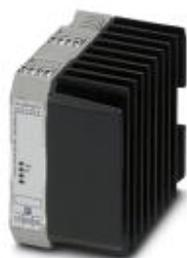
Relè invertitore di carico trifase per semiconduttori con ingresso 24 V DC, corrente d'uscita 9 A, interruttore a tensione zero, su richiesta con fusibile termico
