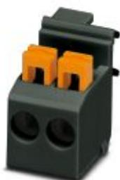
Morsetto per circuiti stampati, corrente nominale: 22 A, tensione di dimensionamento (III/2): 250 V, sezione nominale: 2,5 mm<sup>2</sup>, passo: 5 mm, numero poli: 2, collegamento: Connessione a molla Push-in, montaggio: Saldatura ad onde, direzione di collegamento conduttore/scheda: 0 °, colore: nero, Layout Pin: Pinning lineare, Lunghezza pin [P]: 3,5 mm. Articolo con uscita pin laterale
