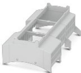
Custodia per guide DIN per l'impiego nei ripartitori di installazione a norma DIN 43880, Parte superiore della custodia con feritoie di ventilazione, larghezza: 161,6 mm, altezza: 89,7 mm, profondità: 54,85 mm, colore: grigio chiaro (7035)
