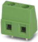
Morsetto per circuiti stampati, corrente nominale: 17,5 A, tensione di dimensionamento (III/2): 630 V, sezione nominale: 1,5 mm<sup>2</sup>, passo: 7,5 mm, numero poli: 2, collegamento: Connessione a vite con gabbia, montaggio: Saldatura ad onde, direzione di collegamento conduttore/scheda: 0 °, colore: verde, Layout Pin: Pinning lineare, Lunghezza pin [P]: 3,5 mm. L'articolo può essere allineato con diversi numeri di poli!
