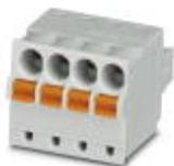
Connettore per circuiti stampati, corrente nominale: 8 A, tensione di dimensionamento (III/2): 160 V, sezione nominale: 1,5 mm<sup>2</sup>, numero poli: 4, passo: 3,5 mm, collegamento: Connessione a molla Push-in, colore: grigio chiaro, superficie contatti: Stagno
