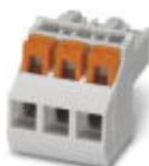
Connettore per circuiti stampati, corrente nominale: 16 A, tensione di dimensionamento (III/2): 300 V, sezione nominale: 2,5 mm<sup>2</sup>, numero poli: 3, passo: 5 mm, collegamento: Connessione a molla Push-in, colore: grigio chiaro, superficie contatti: Stagno, Colore dell'apertura della molla: arancione
