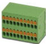
Morsetto per circuiti stampati, corrente nominale: 10 A, tensione di dimensionamento (III/2): 200 V, sezione nominale: 1,5 mm<sup>2</sup>, passo: 3,5 mm, numero poli: 8, collegamento: Connessione a molla Push-in, montaggio: Saldatura ad onde, direzione di collegamento conduttore/scheda: 0 °, colore: verde, Layout Pin: Pinning lineare, Lunghezza pin [P]: 3,5 mm
