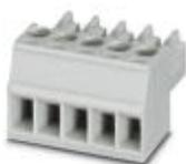
Connettore per circuiti stampati, corrente nominale: 8 A, tensione di dimensionamento (III/2): 160 V, sezione nominale: 1,5 mm<sup>2</sup>, numero poli: 4, passo: 3,5 mm, collegamento: Connessione a vite con gabbia, colore: grigio chiaro, superficie contatti: Stagno
