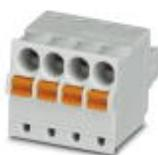
Connettore per circuiti stampati, corrente nominale: 8 A, tensione di dimensionamento (III/2): 160 V, sezione nominale: 1,5 mm<sup>2</sup>, numero poli: 4, passo: 3,5 mm, collegamento: Connessione a molla Push-in, colore: grigio chiaro, superficie contatti: Stagno
