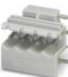
Presa base per circuiti stampati, numero poli: 4, passo: 5 mm, colore: grigio chiaro, superficie contatti: Stagno, layout pin: Pinning lineare, lunghezza pin [P]: 3,5 mm, Articolo con uscita pin laterale
