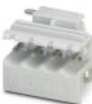
Presa base per circuiti stampati, numero poli: 4, passo: 5 mm, colore: grigio chiaro, superficie contatti: Stagno, layout pin: Pinning lineare, lunghezza pin [P]: 3,5 mm
