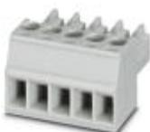
Connettore per circuiti stampati, corrente nominale: 8 A, tensione di dimensionamento (III/2): 160 V, sezione nominale: 1,5 mm<sup>2</sup>, numero poli: 5, passo: 3,5 mm, collegamento: Connessione a vite con gabbia, colore: grigio chiaro, superficie contatti: Stagno
