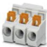
Morsetto per circuiti stampati, corrente nominale: 22 A, sezione nominale: 2,5 mm<sup>2</sup>, passo: 7,5 mm, numero poli: 3, collegamento: Connessione a molla Push-in, montaggio: Saldatura ad onde, direzione di collegamento conduttore/scheda: 0 °, colore: grigio chiaro, Layout Pin: Pinning lineare, Lunghezza pin [P]: 3,5 mm. Articolo con uscita pin laterale
