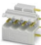
Presa base per circuiti stampati, numero poli: 4, passo: 5 mm, colore: grigio chiaro, superficie contatti: Oro, layout pin: Pinning lineare, Articolo con uscita pin laterale
