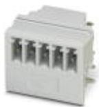
Presa base per circuiti stampati, numero poli: 5, passo: 3,5 mm, colore: grigio chiaro, superficie contatti: Stagno, layout pin: Pinning lineare, lunghezza pin [P]: 2 mm, Articolo con uscita pin laterale
