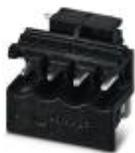
Presa base per circuiti stampati, numero poli: 4, passo: 5 mm, colore: nero, superficie contatti: Stagno, layout pin: Pinning lineare, lunghezza pin [P]: 2,5 mm
