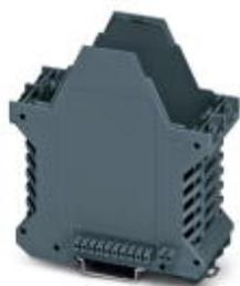
Custodie per guide di montaggio, Base custodia con piedino di fissaggio in metallo, design alto, con feritoie di ventilazione, larghezza: 45,2 mm, altezza: 99 mm, profondità: 107,3 mm, collegamento trasversale: connettore bus integrato, n. poli connettore trasversale: 10+2, colore: blu grigio (7031)
