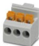
Morsetto per circuiti stampati, corrente nominale: 22 A, tensione di dimensionamento (III/2): 250 V, sezione nominale: 2,5 mm<sup>2</sup>, passo: 5 mm, numero poli: 3, collegamento: Connessione a molla Push-in, montaggio: Saldatura ad onde, direzione di collegamento conduttore/scheda: 0 °, colore: grigio chiaro, Layout Pin: Pinning lineare, Lunghezza pin [P]: 3,5 mm. Articolo con uscita pin laterale
