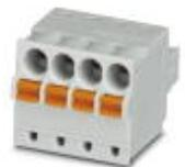
Connettore per circuiti stampati, corrente nominale: 8 A, tensione di dimensionamento (III/2): 160 V, sezione nominale: 1,5 mm<sup>2</sup>, numero poli: 4, passo: 3,5 mm, collegamento: Connessione a molla Push-in, colore: grigio chiaro, superficie contatti: Stagno
