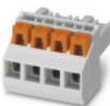
Connettore per circuiti stampati, corrente nominale: 16 A, tensione di dimensionamento (III/2): 300 V, sezione nominale: 2,5 mm<sup>2</sup>, numero poli: 4, passo: 5 mm, collegamento: Connessione a molla Push-in, colore: grigio chiaro, superficie contatti: Stagno, Colore dell'apertura della molla: arancione
