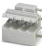
Preso base per circuiti stampati, numero poli: 4, passo: 5 mm, colore: grigio chiaro, superficie contatti: Stagno, layout pin: Pinning lineare, lunghezza pin [P]: 3,5 mm, Articolo con uscita pin laterale
