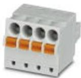
Connettore per circuiti stampati, corrente nominale: 8 A, tensione di dimensionamento (III/2): 160 V, sezione nominale: 1,5 mm<sup>2</sup>, numero poli: 5, passo: 3,5 mm, collegamento: Connessione a molla Push-in, colore: grigio chiaro, superficie contatti: Stagno
