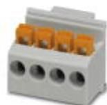
Morsetto per circuiti stampati, corrente nominale: 22 A, tensione di dimensionamento (III/2): 250 V, sezione nominale: 2,5 mm<sup>2</sup>, passo: 5 mm, numero poli: 4, collegamento: Connessione a molla Push-in, montaggio: Saldatura ad onde, direzione di collegamento conduttore/scheda: 0 °, colore: grigio chiaro, Layout Pin: Pinning lineare, Lunghezza pin [P]: 3,5 mm. Articolo con uscita pin laterale
