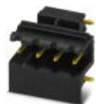
Preso base per circuiti stampati, numero poli: 4, passo: 5 mm, colore: nero, superficie contatti: Oro, layout pin: Pinning lineare, lunghezza pin [P]: 2,5 mm, Articolo con uscita pin laterale
