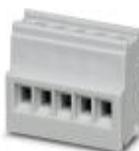
Morsetto per circuiti stampati, passo: 3,5 mm, numero poli: 5, colore: grigio chiaro, Layout Pin: Pinning lineare, Lunghezza pin [P]: 3 mm. Articolo con uscita pin laterale
