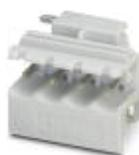
Preso base per circuiti stampati, numero poli: 4, passo: 5 mm, colore: grigio chiaro, superficie contatti: Stagno, layout pin: Pinning lineare, lunghezza pin [P]: 3,5 mm
