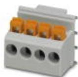
Morsetto per circuiti stampati, corrente nominale: 22 A, tensione di dimensionamento (III/2): 250 V, sezione nominale: 2,5 mm<sup>2</sup>, passo: 5 mm, numero poli: 4, collegamento: Connessione a molla Push-in, montaggio: Saldatura ad onde, direzione di collegamento conduttore/scheda: 0 °, colore: grigio chiaro, Layout Pin: Pinning lineare, Lunghezza pin [P]: 3,5 mm. Articolo con uscita pin laterale
