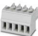
Connettore per circuiti stampati, corrente nominale: 8 A, tensione di dimensionamento (III/2): 160 V, sezione nominale: 1,5 mm<sup>2</sup>, numero poli: 5, passo: 3,5 mm, collegamento: Connessione a vite con gabbia, colore: grigio chiaro, superficie contatti: Stagno
