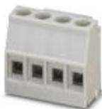
Morsetto per circuiti stampati, corrente nominale: 24 A, tensione di dimensionamento (III/2): 400 V, sezione nominale: 2,5 mm<sup>2</sup>, passo: 5 mm, numero poli: 4, collegamento: Connessione a vite con gabbia, montaggio: Saldatura ad onde, direzione di collegamento conduttore/scheda: 0 °, colore: grigio chiaro, Layout Pin: Pinning lineare, Lunghezza pin [P]: 3,5 mm. Articolo con uscita pin laterale
