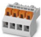
Connettore per circuiti stampati, corrente nominale: 16 A, tensione di dimensionamento (III/2): 300 V, sezione nominale: 2,5 mm<sup>2</sup>, numero poli: 4, passo: 5 mm, collegamento: Connessione a molla Push-in, colore: grigio chiaro, superficie contatti: Stagno, Colore dell'apertura della molla: arancione
