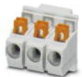
Morsetto per circuiti stampati, corrente nominale: 22 A, sezione nominale: 2,5 mm<sup>2</sup>, passo: 7,5 mm, numero poli: 3, collegamento: Connessione a molla Push-in, montaggio: Saldatura ad onde, direzione di collegamento conduttore/scheda: 0 °, colore: grigio chiaro, Layout Pin: Pinning lineare, Lunghezza pin [P]: 3,5 mm. Articolo con uscita pin laterale
