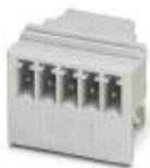
Presa base per circuiti stampati, numero poli: 5, passo: 3,5 mm, colore: grigio chiaro, superficie contatti: Stagno, layout pin: Pinning lineare, lunghezza pin [P]: 2 mm, Articolo con uscita pin laterale
