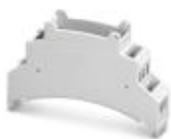
Custodia per guide DIN per l'impiego nei ripartitori di installazione a norma DIN 43880, Parte superiore della custodia per morsetti per circuiti stampati con connessione a vite, larghezza: 17,8 mm, altezza: 89,7 mm, profondità: 53,4 mm, colore: grigio chiaro (7035)
