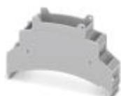
Custodia per guide DIN per l'impiego nei ripartitori di installazione a norma DIN 43880, Parte superiore della custodia per morsetti per circuiti stampati con connessione a vite, larghezza: 17,8 mm, altezza: 89,7 mm, profondità: 53,4 mm, colore: grigio chiaro (7035)
