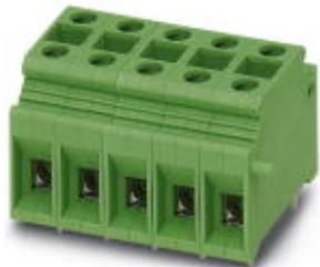
Morsetto per circuiti stampati, corrente nominale: 76 A, tensione di dimensionamento (III/2): 320 V, sezione nominale: 10 mm<sup>2</sup>, passo: 10 mm, numero poli: 1, collegamento: Connessione a vite con gabbia, montaggio: Saldatura ad onde, direzione di collegamento conduttore/scheda: 0 °, colore: nero, Layout Pin: Piedinatura doppia lineare, Lunghezza pin [P]: 4,3 mm
