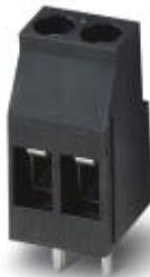
Morsetto per circuiti stampati, corrente nominale: 24 A, tensione di dimensionamento (III/2): 320 V, sezione nominale: 2,5 mm<sup>2</sup>, passo: 5 mm, numero poli: 2, collegamento: Connessione a vite con gabbia, montaggio: Saldatura THR, direzione di collegamento conduttore/scheda: 0 °, colore: nero, Layout Pin: Pinning lineare, Lunghezza pin [P]: 3,5 mm
