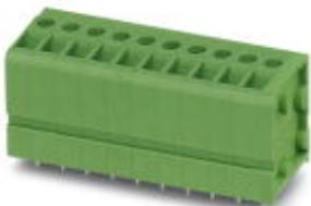
Morsetto per circuiti stampati, corrente nominale: 24 A, tensione di dimensionamento (III/2): 400 V, sezione nominale: 2,5 mm<sup>2</sup>, passo: 5 mm, numero poli: 11, collegamento: Connessione a vite frontale, montaggio: Saldatura ad onde, direzione di collegamento conduttore/scheda: 90 °, colore: verde, Layout Pin: Piedinatura doppia lineare, Lunghezza pin [P]: 3,5 mm
