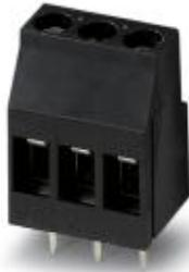
Morsetto per circuiti stampati, corrente nominale: 24 A, tensione di dimensionamento (III/2): 320 V, sezione nominale: 2,5 mm<sup>2</sup>, passo: 5 mm, numero poli: 3, collegamento: Connessione a vite con gabbia, montaggio: Saldatura THR, direzione di collegamento conduttore/scheda: 0 °, colore: nero, Layout Pin: Pinning lineare, Lunghezza pin [P]: 5 mm. Questo articolo può essere saldato con componenti SMD nel forno reflow.
